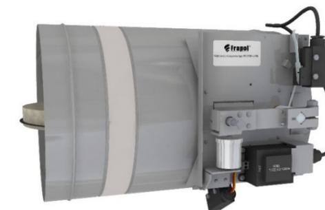
Типоряд выпускаемых клапанов этого типа совместим с диаметрами, рекомендуемыми PN-EN 1506, и составляет:  $D = 100, 125, 160, 200, 250$  и  $315$  мм. Клапаны соединяются с воздуховодами вентиляционной системы при помощи ниппельного или муфтового соединения. Полная длина клапанов составляет  $370$  мм, а для варианта ER -  $270$
