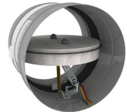
В стандартном варианте исполнения противопожарные клапаны типа RK150 круглого сечения из одночастного перфорированного корпуса, изготовленного из оцинкованной листовой стали, запорной заслонки, изготовленной из огнестойкой плиты Promatect, подвешенной на шкворнях, вентиляционного и расширяющегося уплотнителя, теплового замка, закрывающей пружины и дополнительных элементов, таких как: зацепы и ограничитель движения запорной заслонки для закрытого положения.
